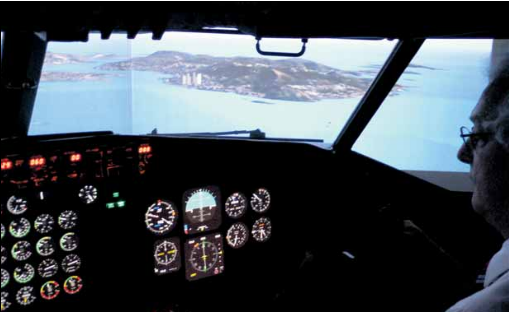
Auch ohne aufwendige Bewegungshydraulik kann der Dübendorfer Simulator eine täuschend echte Illusion eines Flugs erzeugen.
