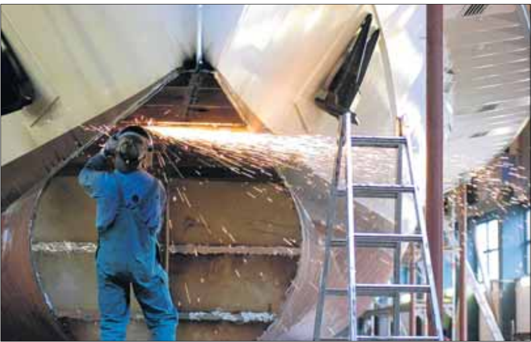
Ein Mitarbeiter der Herstellerfirma trifft am Motorschiff «Panta Rhei» Vorbereitungen für die Montage des neuen, voluminöseren Bugwulstes.
