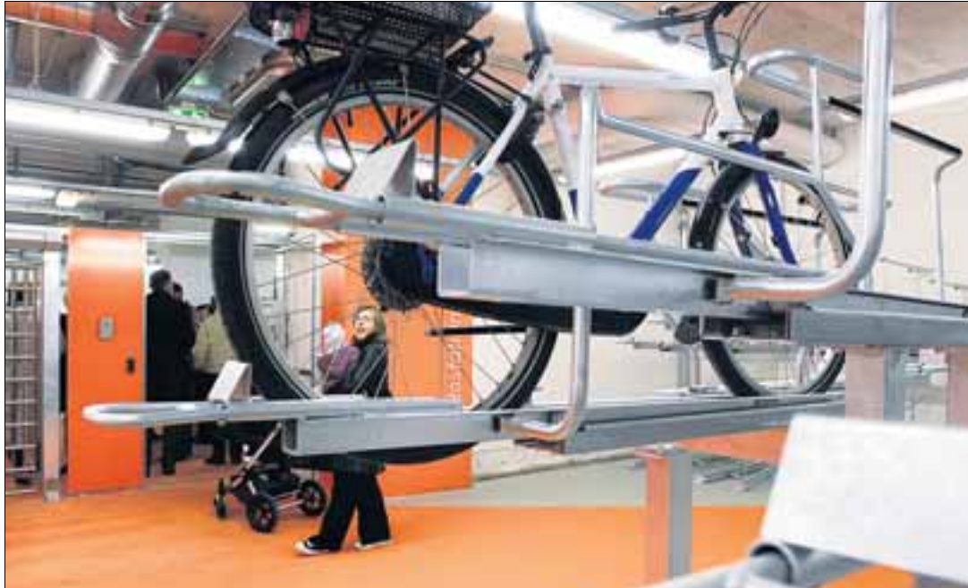
Velos werden in der unterirdischen Velostation Süd mit einer Schiebevorrchtung versorgt.
